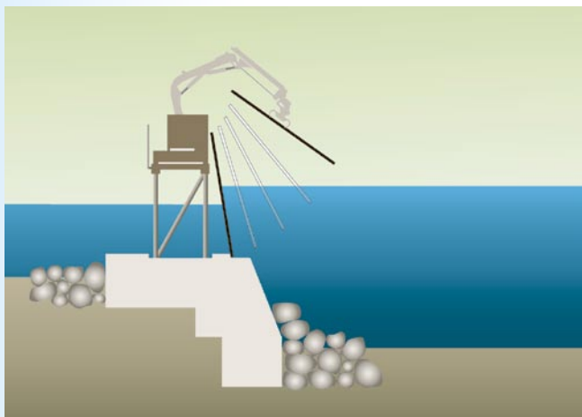
Schnitt durch das Längswehr mit motorisiertem Nadelsetzgerät
