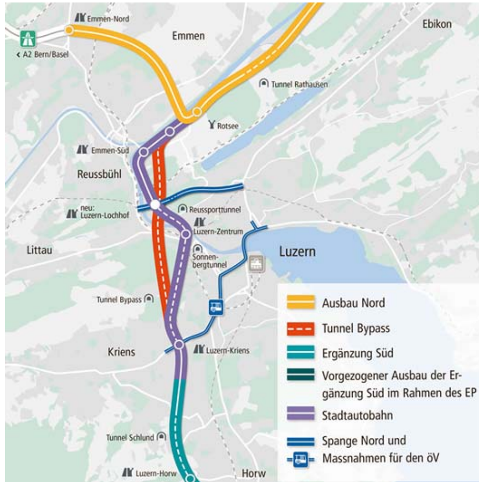
Abb. 2: Bisher geplantes «Vorprojekt optimiert» der Spange Nord mit Gesamtsystem Bypass (Quelle: www.bypasslu.ch )
