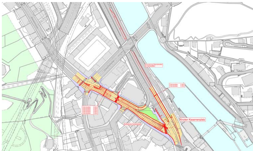
Abb. 26: Anpassung Verkehrsregime und Ausbauten am Kasernenplatz, Basisausbau
