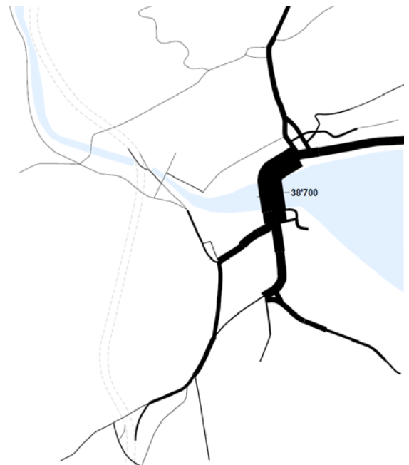
Abb. 14: Streckenspinne DTV Referenzzustand 2040 für die Seebücke
